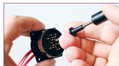
引抜工具による簡単なコンタクトの取り外し
